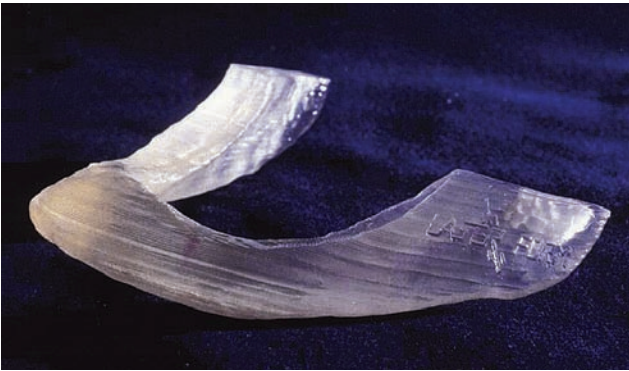
Abb. 1. SLA-Modell eines zahnlosen Unterkiefers, hergestellt nach CT-Daten
